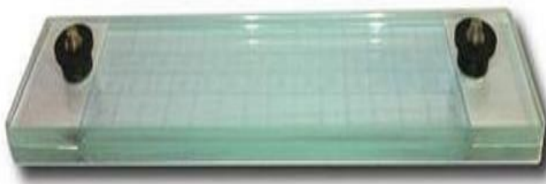
Рисунок 6. Компрессориум для выявления трихинелл в мясе.
