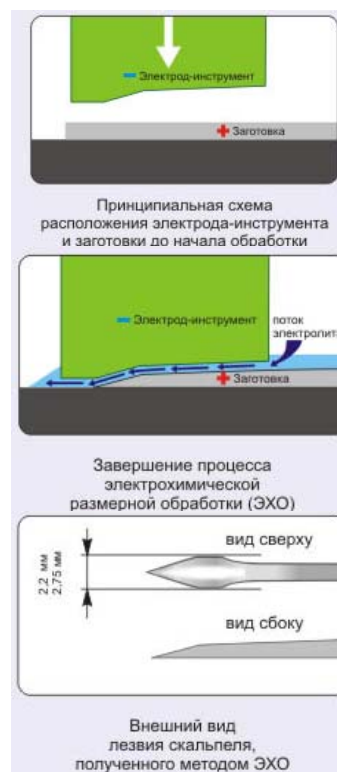
Рис. 1. Принципиальная схема электрохимической размерной обработки скальпелей
