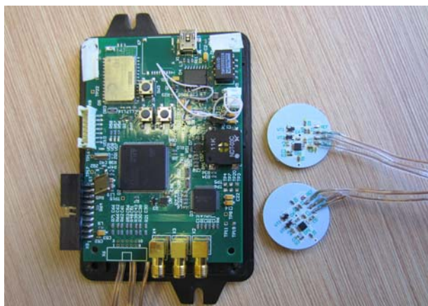
Рис.2. Прототип датчика для бесконтактного измерения ЭКГ
