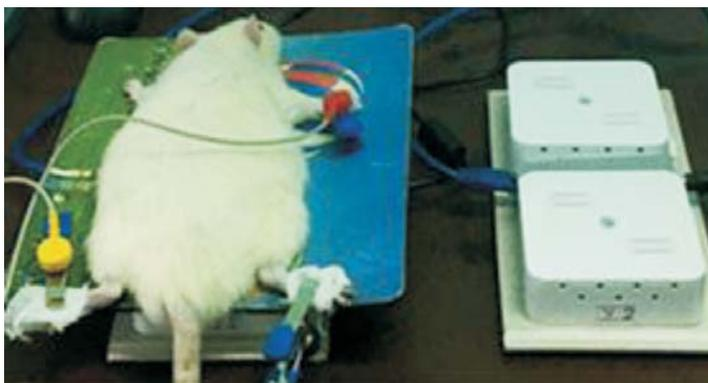
Рис. 1. Полеформирующая система и лабораторная крыса с ЭКГ электродами
