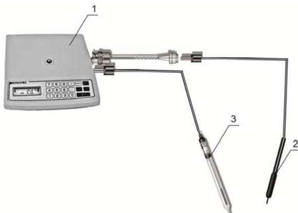
Рис.1 1 – мультитест ИПЛ-301; 2 – измерительный металлический электрод; 3 – хлорсеребряный электрод сравнения
