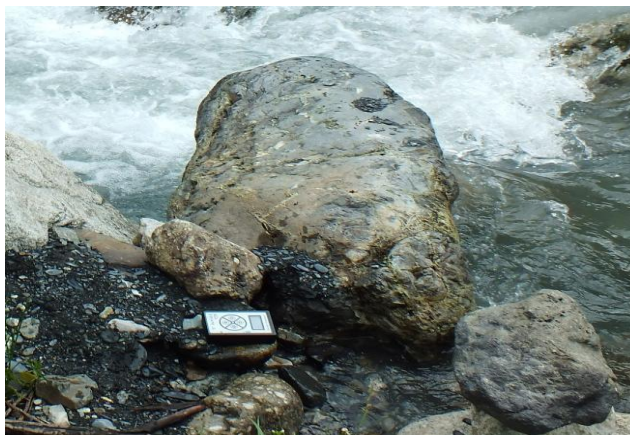
Рис. 1. Место замера \gamma -излучения - ДКГ-03Д «Грач» и у самого берега, расстояние до уреза воды 15 см
