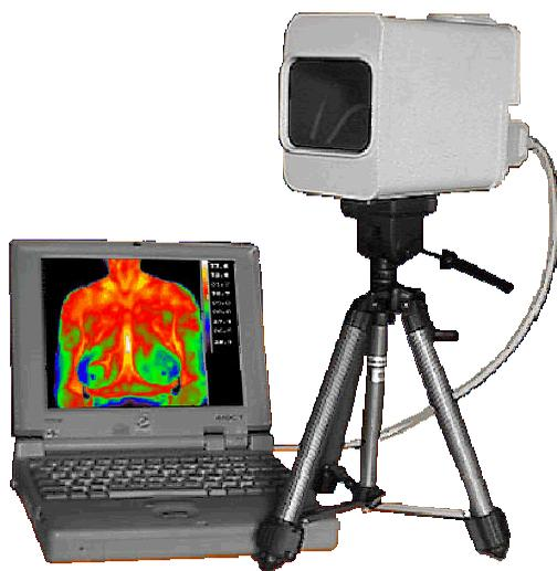
Рис. 11. Портативный компьютерный термограф ИРТИС-2000
